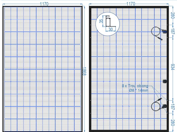
1.Tolérance de 2mm sur longueur et largeur; 2. Les longueurs mentionnées peuvent être sujettes à ajustements techniques; 3.Standard Test Conditions,1000W/m<sup>2</sup>,25°C, AM1,5; 4.Normal operating cell temperature, 800 W/m<sup>2</sup>, 45°; Tolérance sur Pmax et incertitude de mesure sur les caractéristiques électriques : ±3%
