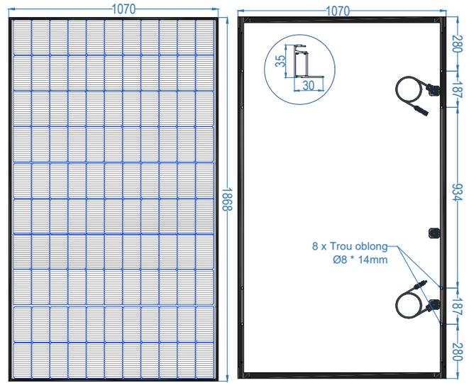
1.Tolérance de 2mm sur longueur et largeur; 2. Les longueurs mentionnées peuvent étre sujettes à ajustements techniques; 3.Standard Test Conditions,1000W/m<sup>2</sup>, 25°C, AM1,5; 4.Normal operating cell temperature, 800 W/m<sup>2</sup>, 45°; Tolérance sur P<sub>max</sub> et incertitude de mesure sur les caractéristiques électriques : ±3%
