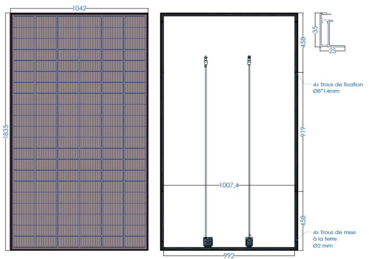
1.Tolérance de 2mm sur longueur et largeur; 2.Tolérance de ±0,7kg sur le poids du module; 3.Standard Test Conditions,1000W/m<sup>2</sup>,25°C,AM1,5; 4.Normal operating cell temperature, 800 W/m<sup>2</sup>,45°; Tolérance sur P<sub>max</sub>: ±3%. Incertitude de mesure sur les caractéristiques électriques: ±3%
